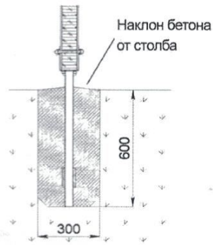
Установка в грунт
